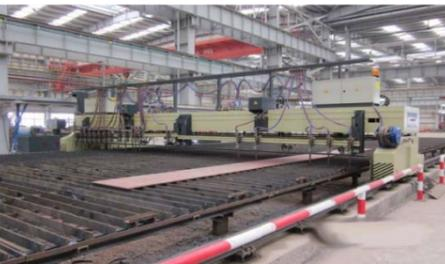
图 1 数控多头火焰直条切割机
